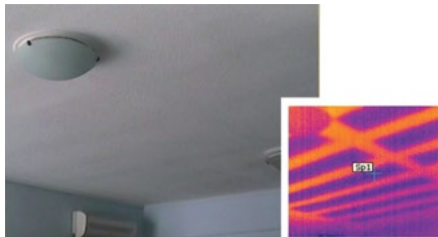
Θερμική ακτινοβολία μη επαρκώς θερμομονωμένης πλάκας (Zoellner)
